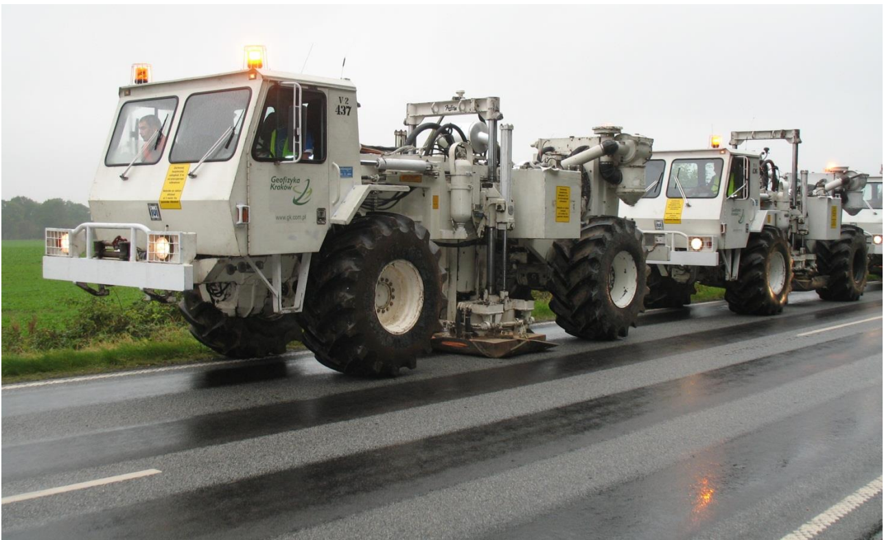
Figur 15: Vibratorkøretøjer i arbejde. Ved at bruge flere køretøjer, der anvender deres vibratorer synkront, forstærkes lydbølgerne til undergrunden. Herved opnås et bedre seismisk signal og dermed et mere detaljeret billede af undergrunden.
